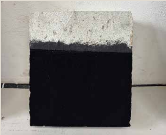
Materialprobe zum Farbauftrag mit pigmentierter Schlämme und Spinellschwarz auf Trachytstein.
