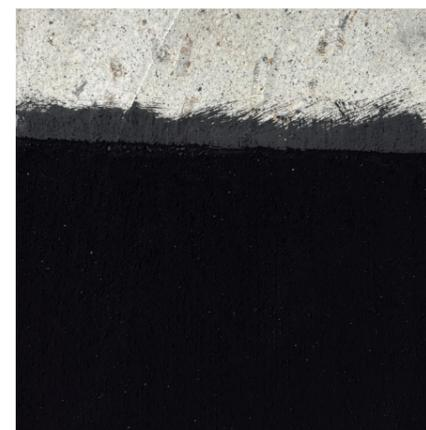
Aufbau mit pigmentierter Schlämme und Spinellschwarz auf Trachyte Stein
